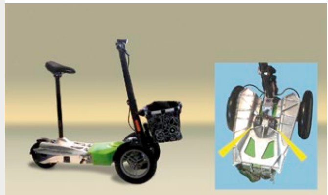
Strukturdämpfer erhöhen Fahrkomfort eines Elektro-Scooters
