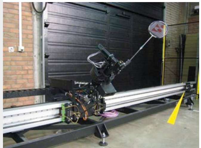
Unterschiedliche Dämpfer bremsen schnelle Bewegungen eines Badminton-Roboters FMTC vzw, 3001 Leuven, Belgien
