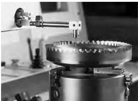
Computervermessung eines Zahnprofils
