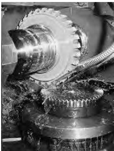
CNC-Bearbeitung eines PowerTRUE™ Zahnrades in rechtwinkliger Bauform
